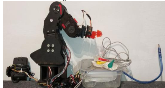
Fig. 6 Manufactura del BCI mediante el AD832- DSPIC y Mathbot.
